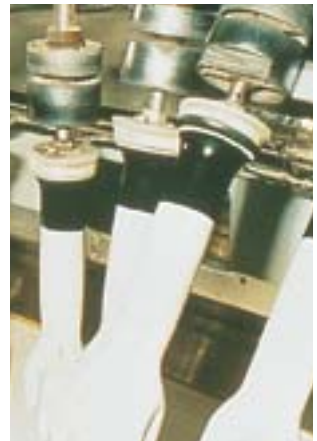
Herstellung von Latexhandschuhen im Tauchverfahren
